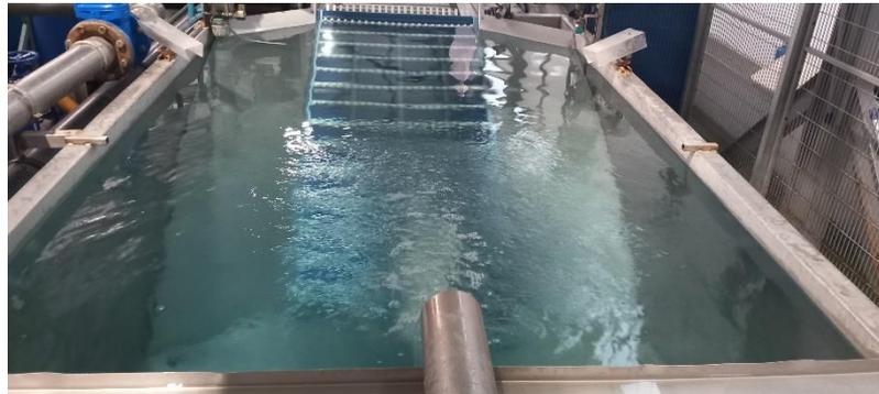
*Fotografías 1 y 2. A la izquierda, detalle del depósito con 1500kg de carbón activado (rectangular); derecha, aspecto del agua de la balsa después de haberse filtrado durante 10h por el carbón activado*
