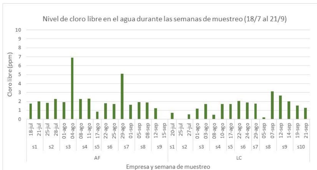
**Figura 5.** Nivel de cloro libre (ppm) en el agua de las balsas de la empresa AF y LC durante las 9 semanas de seguimiento
